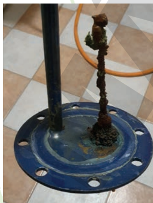
Elektrokémiai korrózió egyik következménye a gyors anódfogyás, ezért indokolt az első anódcseré 12 hónappánál, így annak jelentős fogyása esetén még idejében feltárható a probléma a tároló test sérülése nélkül (azt követően 18 hónap).
